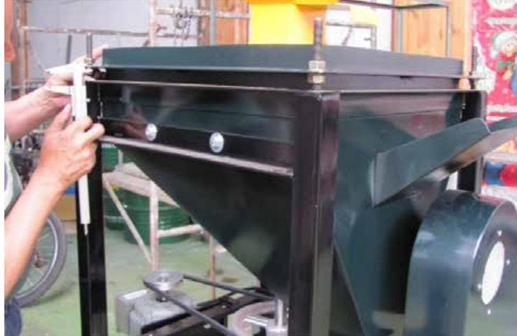
**Figura 75.** Calibración de la separación de los discos peladores. Calderon 2019
