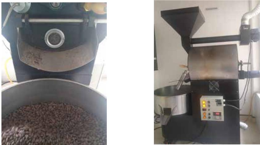
**Figura 59.** *Ventanilla de la tostadora para observar el grano (Izquierda). Partes y controles de la tostadora. Calderon 2019*
